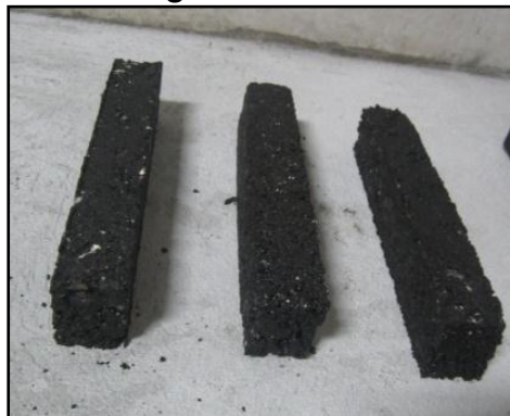
Figura 2-6. Vigas de concreto asfáltico
