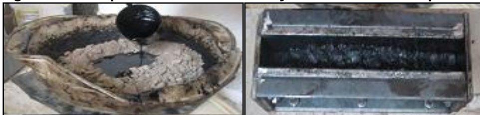
Figura 2-4. Preparación de la mezcla y elaboración de la probeta
