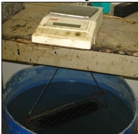
Figura 2-7. Peso sumergido de las vigas
