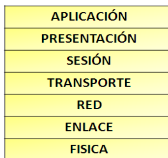
Figura 1 Esquema jerárquico por capas del modelo OSI
