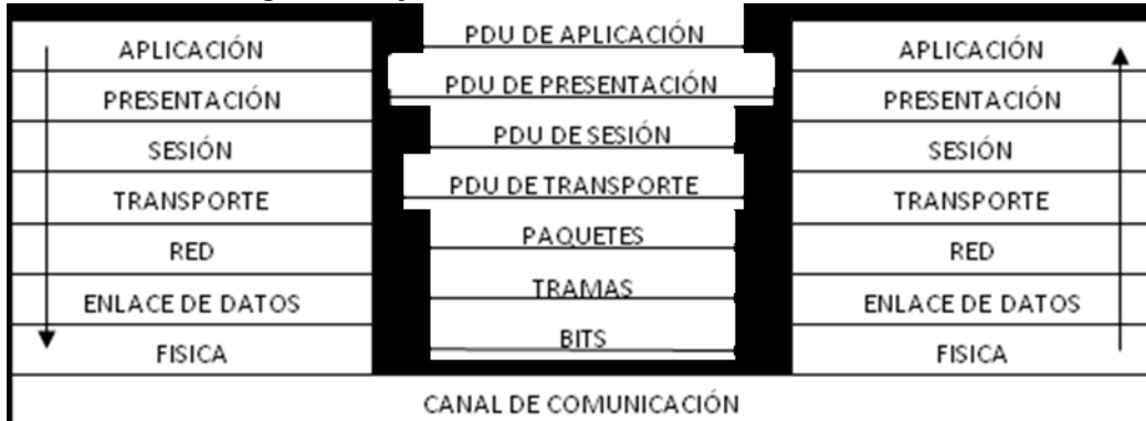
Figura 2 Flujo de la información en el modelo OSI
