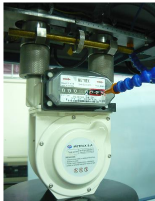
Figura 38. Montaje Sistema De Acoplamiento
