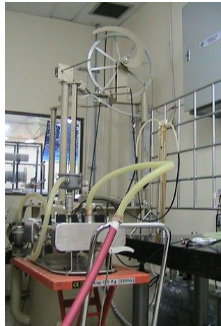
Figura 64. Calibración Banco Patrón Con Campana Gasométrica
