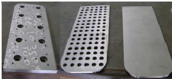
Figura 16. Alojamiento boquillas, baffle y cara posterior Plenum In
