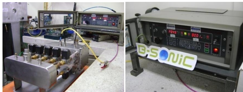
Figura 65. Prueba De Fugas Con El ATeQ
