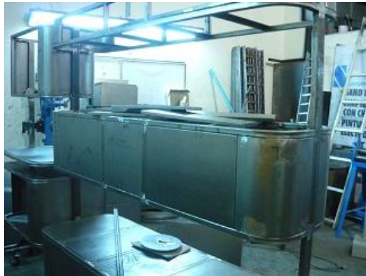
Figura 52. Montaje De Láminas Desmontables
