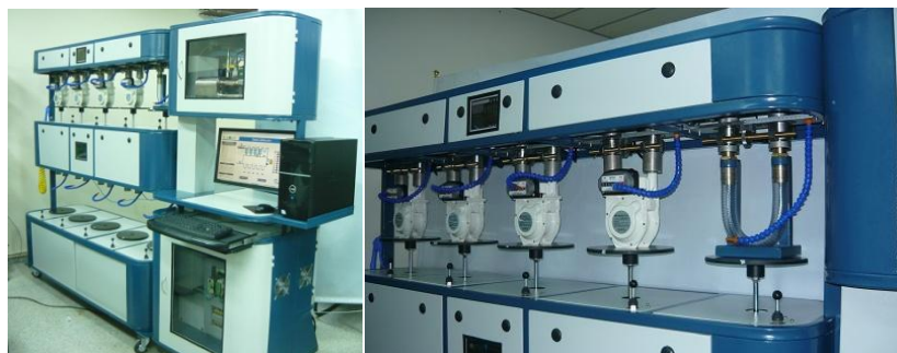
Figura 66. Montaje Prueba De Calibración De Medidores En La Facilidad Tecnológica
