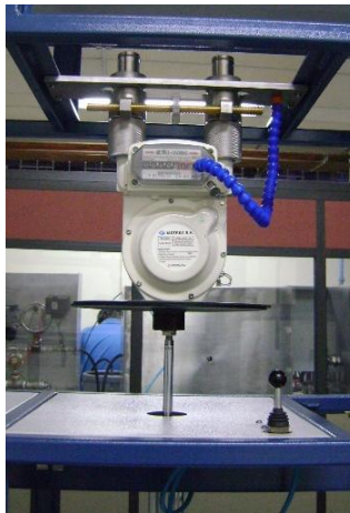
Figura 56. Montaje Del Sistema De Soporte Y Conexión De Medidores
