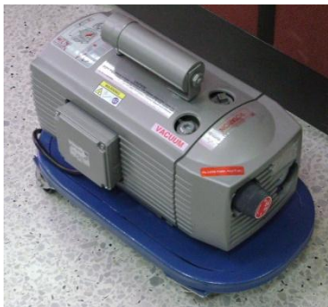
Figura 45. Montaje De La Bomba De Vacío
