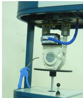
Figura 41. Montaje Base Medidor Y Sistema De Acople
