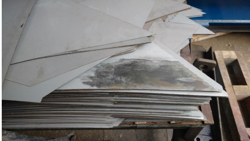
Figura 9. Láminas de núcleo transformador 7.5 MVA
