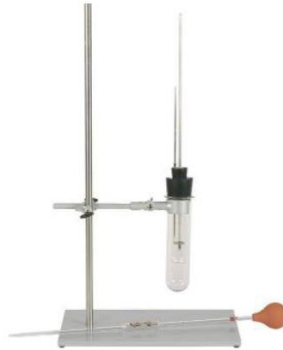
Figura 23. Equipo manual para determinación del punto de anilina
