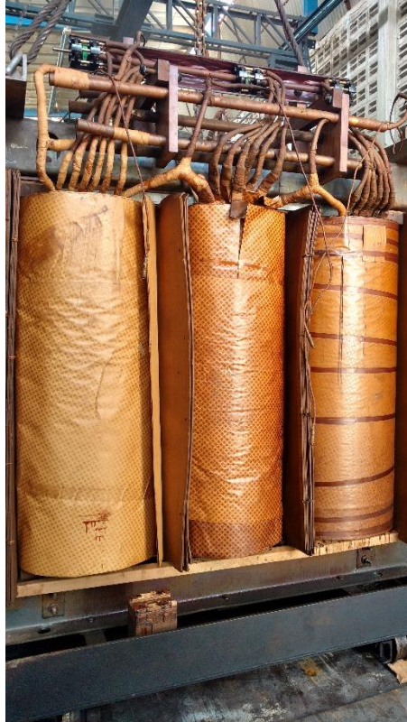
Figura 7. Parte activa transformador 7.5 MVA
