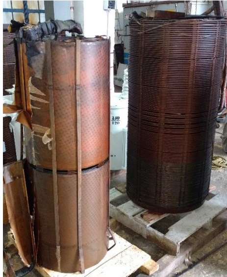
Figura 8. Bobinas de devanados primario (derecha) y secundario (izquierda) de transformador 7.5 MVA
