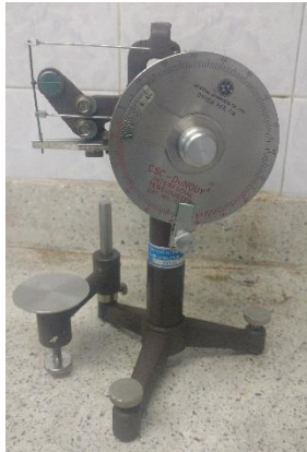
Figura 22. Equipo para medición de la tensión interfacial
