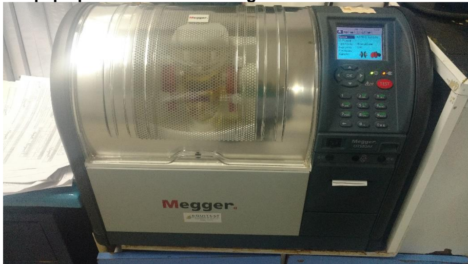
Figura 26. Equipo para medición de la rigidez dieléctrica
