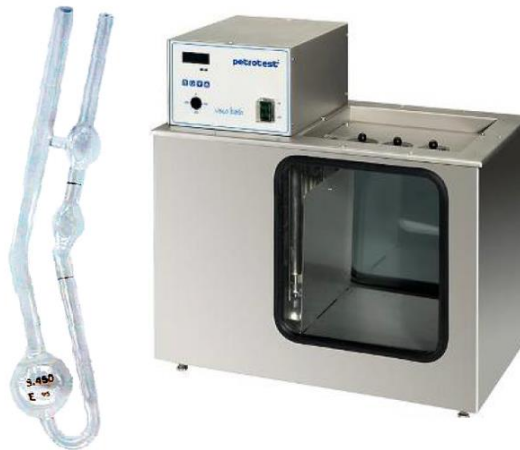
Figura 19. Equipo para medición de la viscosidad Cinemática y Absoluta
