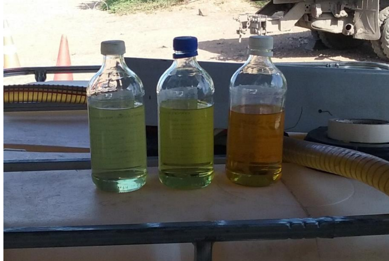
Figura 58. Cambio de color en un proceso de regeneracion.
