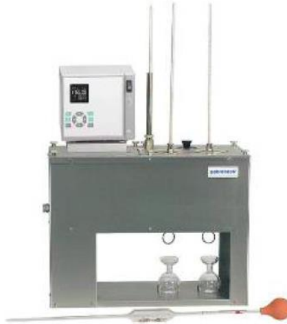
Figura 18. Equipo para medición de viscosidad Saybolt Universal
