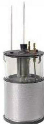
Figura 20. Equipo para medición del punto de fluidez
