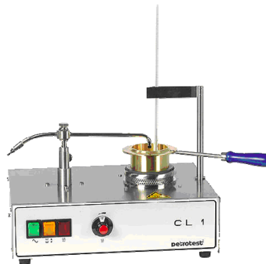
Figura 21. Equipo para determinación de punto de llama y de punto de combustión
