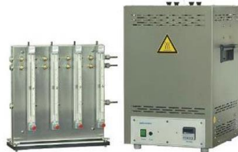
Figura 25. Equipo para determinación de la estabilidad a la oxidación
