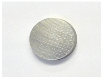
Figura 5. Sustrato de acero AISI SAE 1020.
