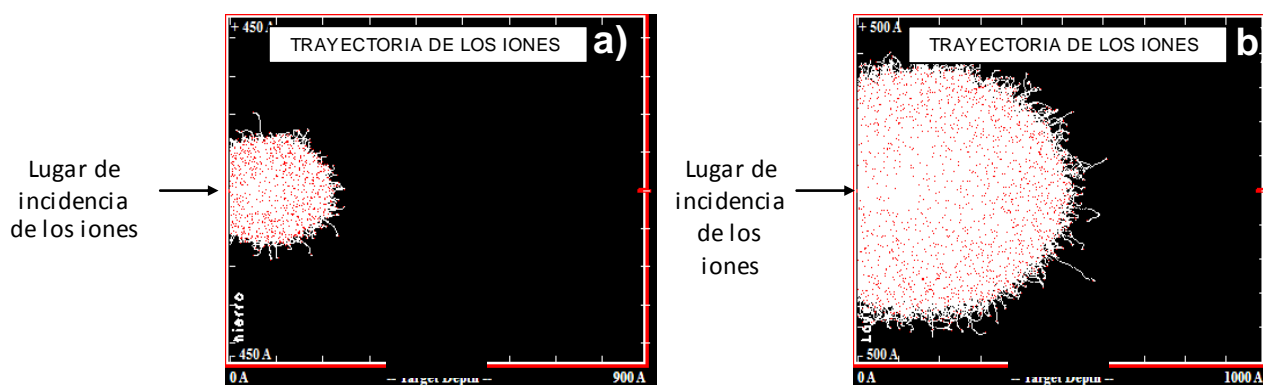
Figura 13. Trayectoria de los iones de Ti+N. a) iones de Ti y b) iones de N.
