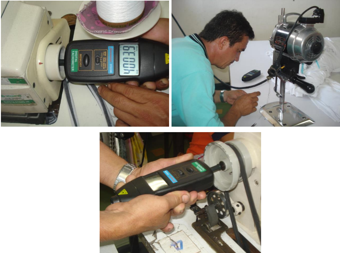
Figura 30. Medición de RPM de los equipos
