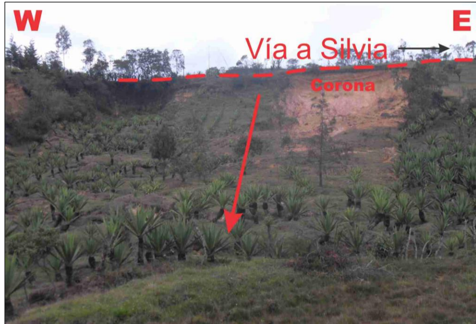
Figura 20. Deslizamiento traslacional de tierras con desarrollo de erosión en surcos.
