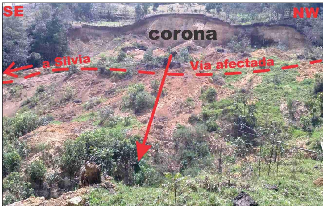
Figura 22. Deslizamiento rotacional vereda Manchei en Vía Silvia-Jambaló, Quebrada Manchei.
