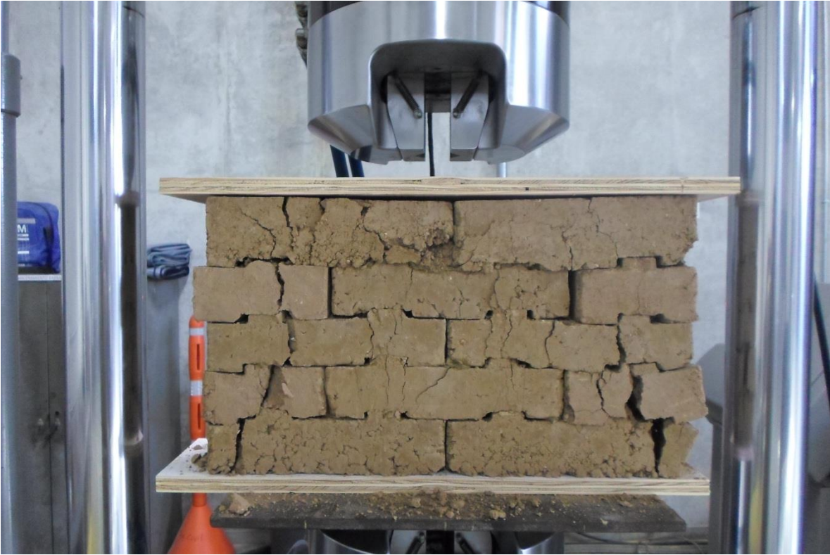
Figura 85. Vista frontal murete fallado
