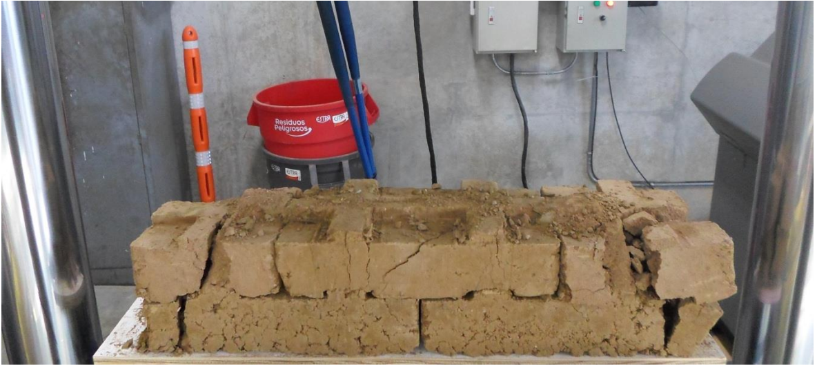
Figura 94. Segunda hilada fallada
