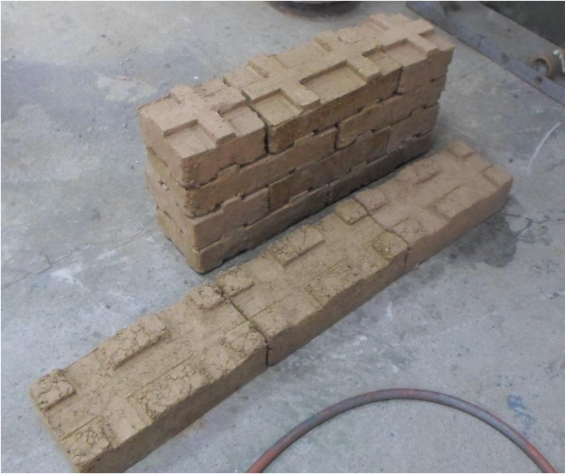
Figura 79. Formación del murete
