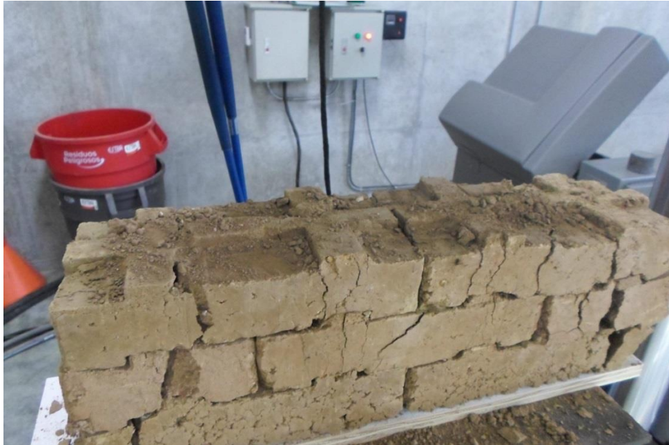
Figura 92. Tercera hilada fallada
