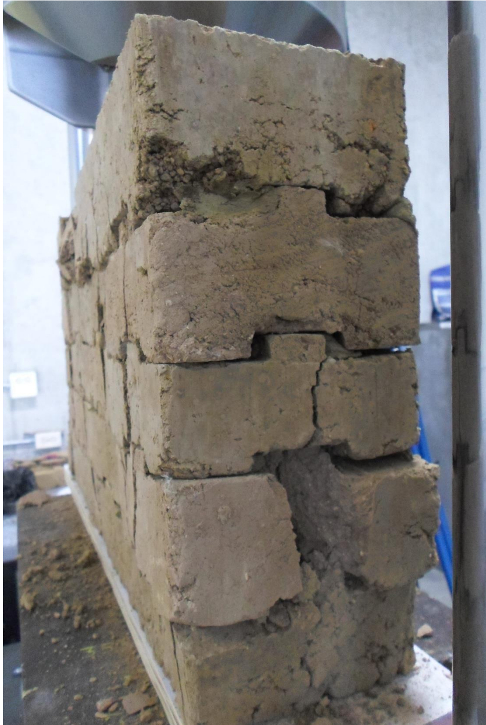
Figura 86. Vista lateral derecha del murete fallado
