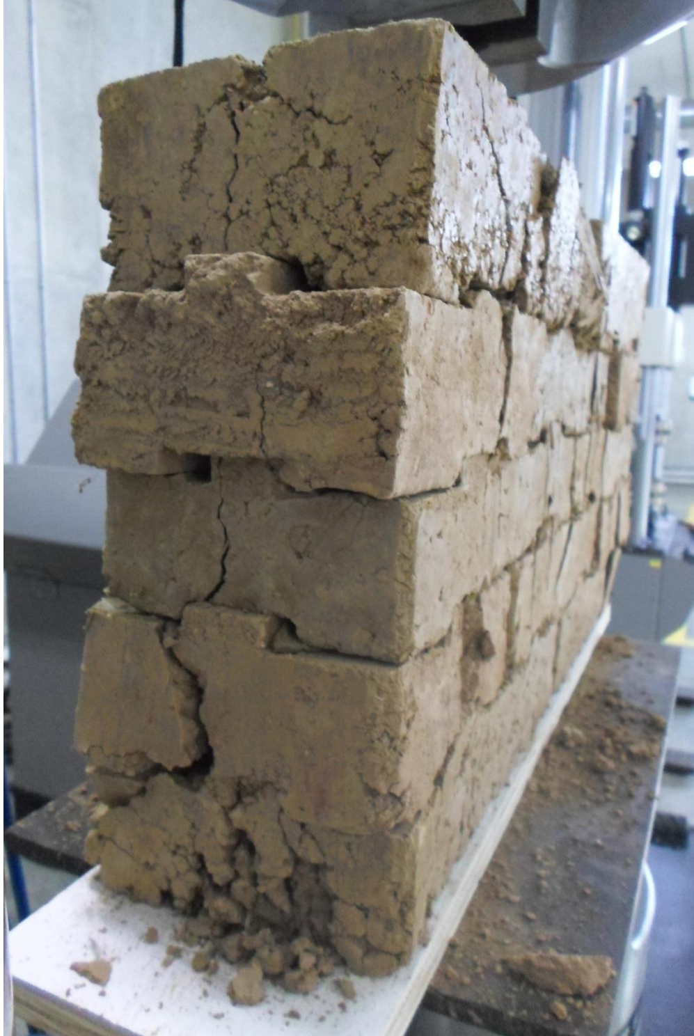
Figura 87. Vista lateral izquierda murete fallado
