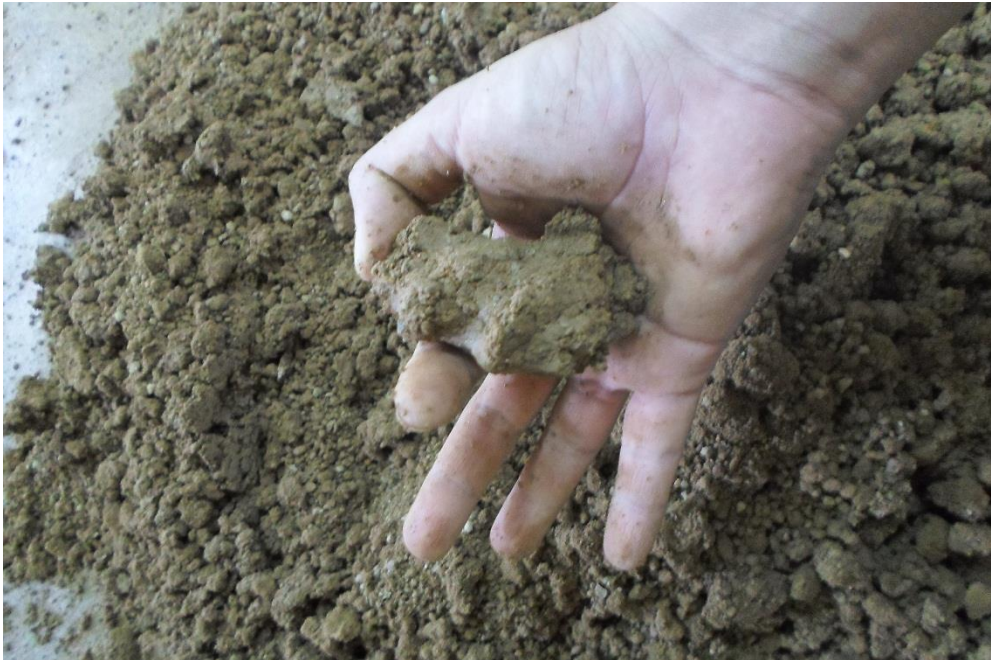
Figura 43. Prueba de humedad
