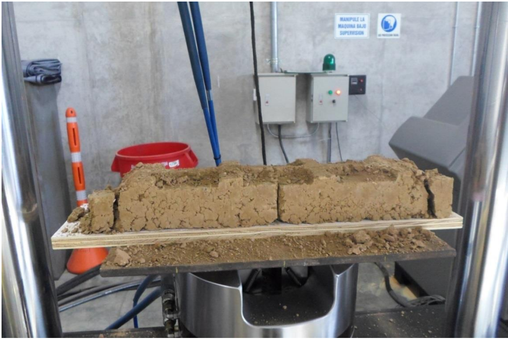
Figura 97. Primera hilada fallada
