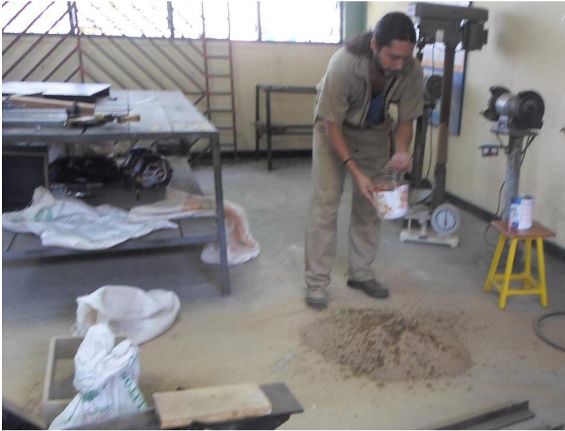
Figura 40. Aplicación de agua a la mezcla
