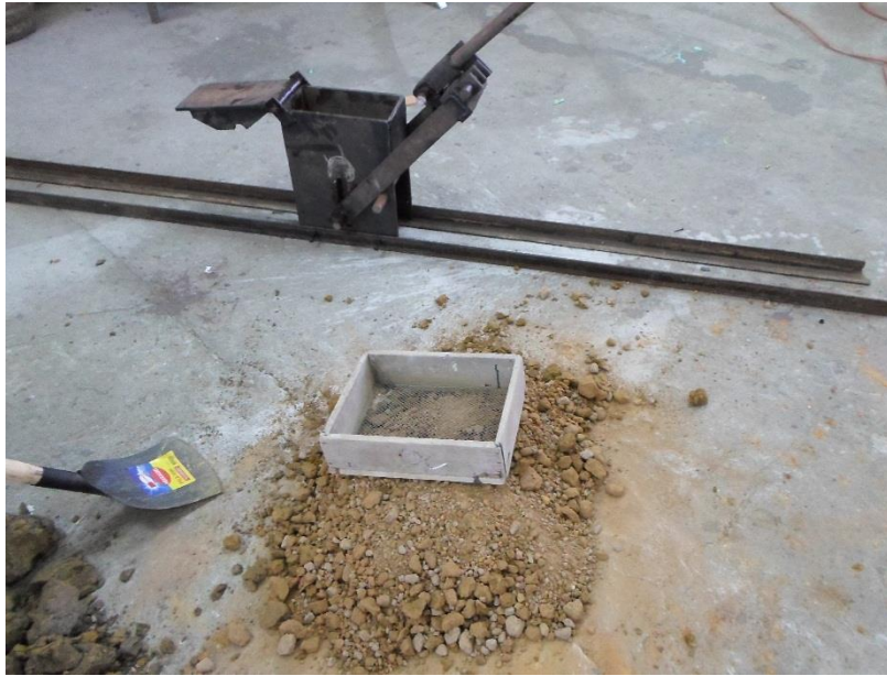
Figura 26. Preparación de la tierra
