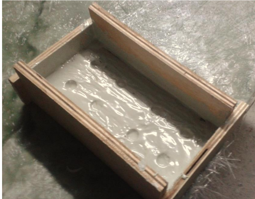
Figura 30. Elaboración del molde alternativa uno
