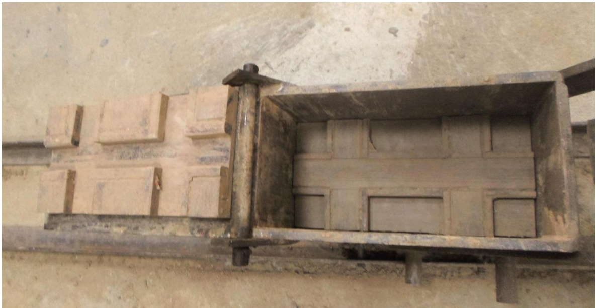
Figura 44. Acomodación de los moldes en la bloquera
