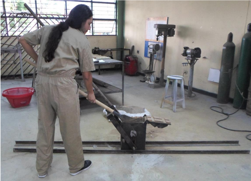
Figura 45. Llenado de la prensa
