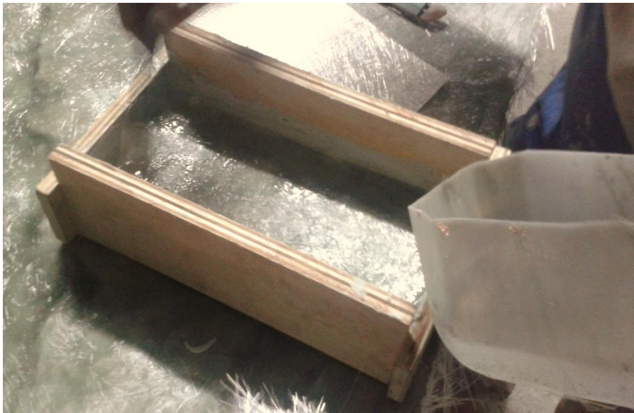
Figura 29. Elaboración del molde alternativa uno
