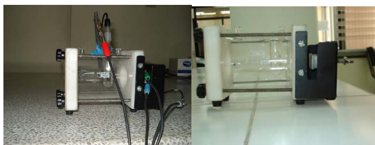
Figura 12. Esquema del montaje realizado para EIS y celda plana utilizada.
