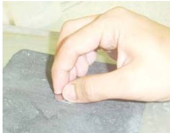
Figura 10. Proceso de Lijado de los sustratos
