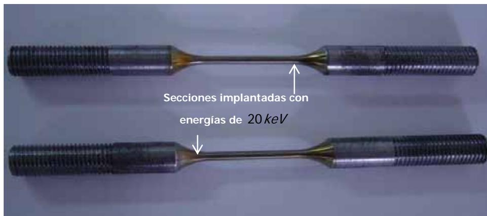
**Fig. 5. 3** Probetas implantadas con energías de 20 keV
