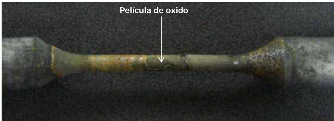
**Fig. 5. 11 Película de oxido formada a lo largo de la sección de cintura**
