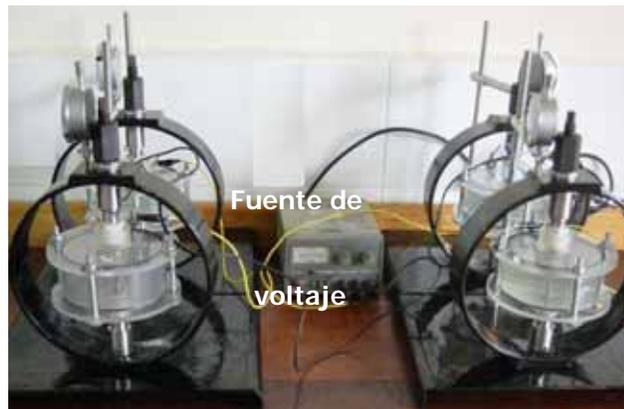
Fig. 4. 15 Equipo de anillos tensores para las pruebas de corrosión bajo esfuerzos
