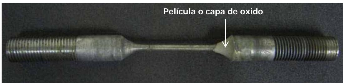
**Fig. 5. 10 Película de óxido formada en la parte externa de la sección de cintura**
