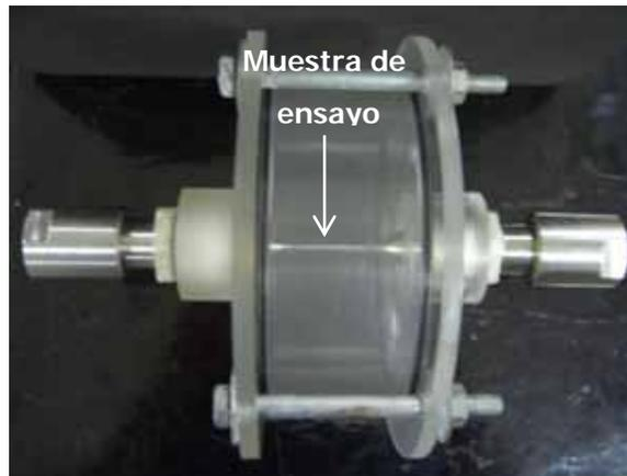
Fig. 4. 13 Muestra de ensayo acoplada en la celda de PVC
