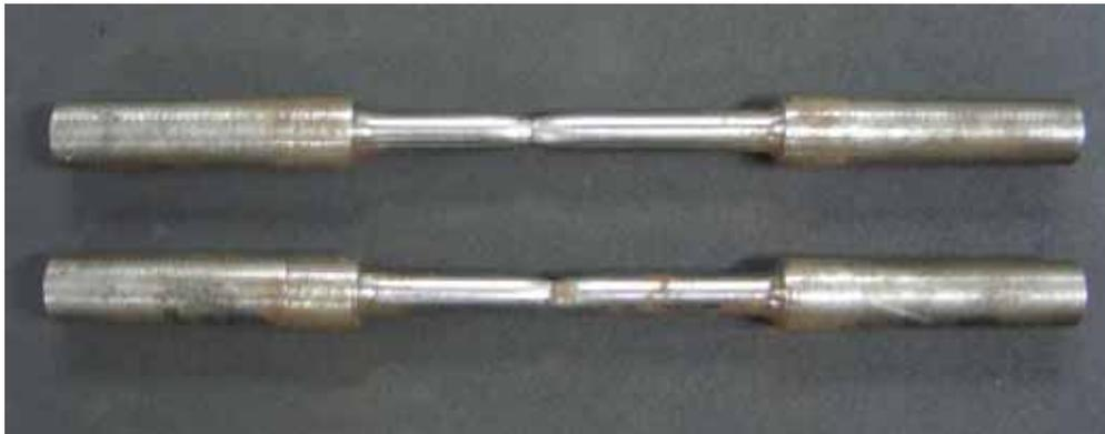
Fig. 5. 9 Probetas ensayadas mediante tensión para las que se obtuvo el límite elástico
