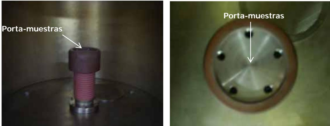
Fig. 4. 7 Porta muestras de acero en el cátodo
