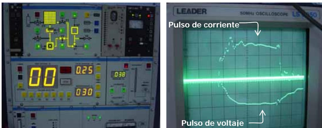
Fig. 4. 10 Panel de control del JUPITER (izquierda) y registro de los pulsos de voltaje y corriente en el osciloscopio (derecha)
