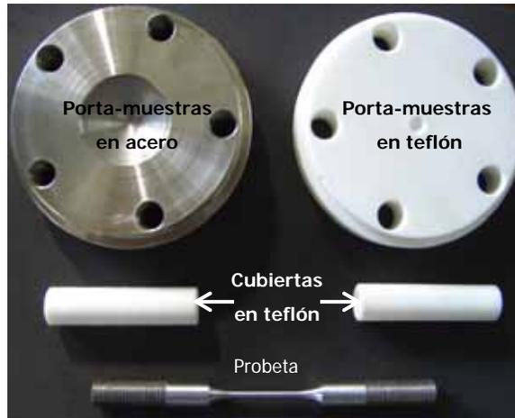
Fig. 4. 2 Accesorios del montaje de la probeta en el JUPITER
