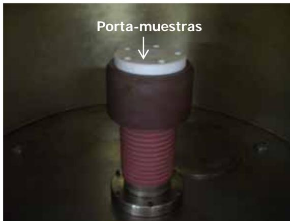
Fig. 4. 8 Porta-muestra de teflón en el cátodo
