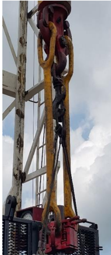
Figura 66. Amarre de preventora a gancho de varilla.
