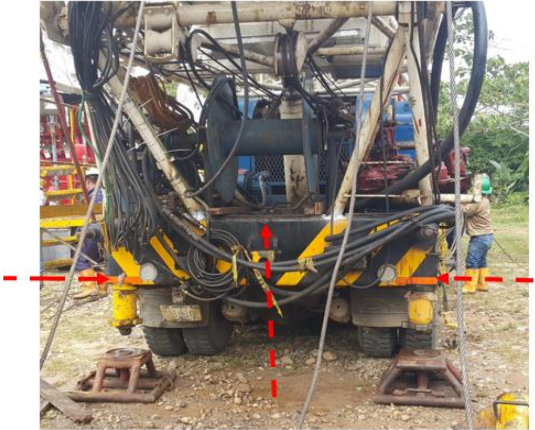
Figura 20. Lugar de la cinta métrica al momento de centrar la unidad básica
