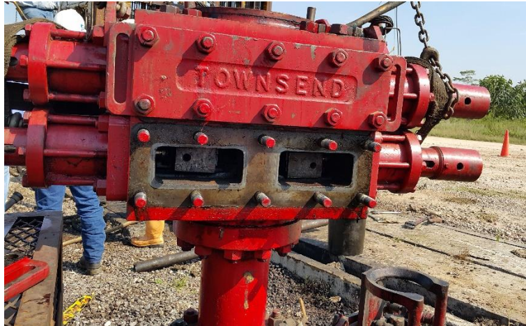
Figura 57. Modulo abierto de la BOP
