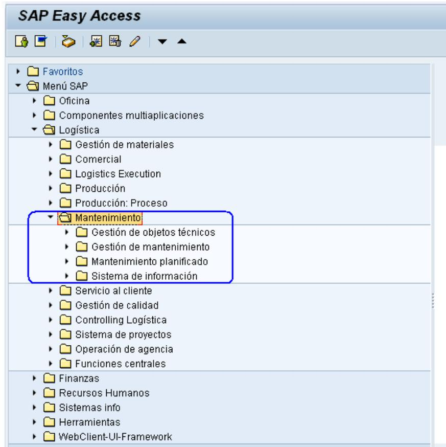
El módulo PM se comunica con el de materiales a través de transacciones que permiten ligar repuestos y servicios de manera exclusiva a cada equipo<sup>4</sup>, de esta forma podemos obtener datos sobre las reparaciones y los elementos utilizados en ellos, igualmente podemos preparar labores de mantenimiento basados en el historial de intervenciones planeando efectivamente una intervención futura.
