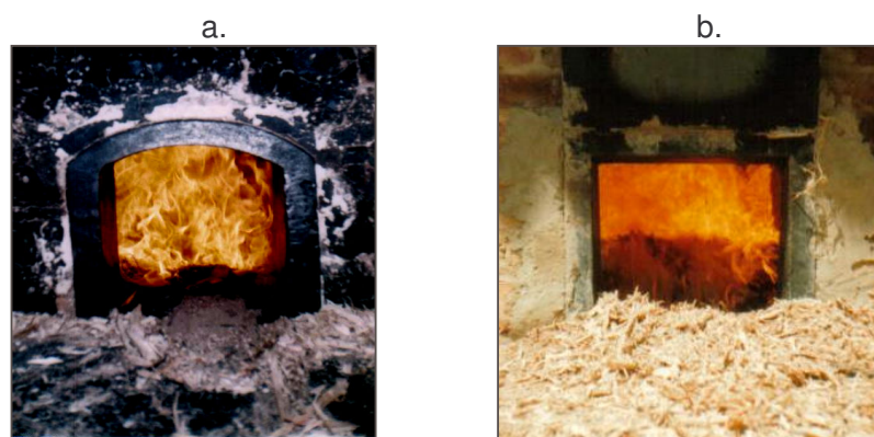
Figura 12. Compuertas de alimentación del bagazo de la cámara Ward-CIMPA (a) y de la Plana-CIMPA (b).
