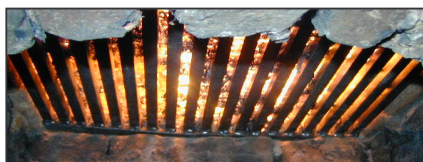
Figura 6. Parrilla de un horno up-draft.
