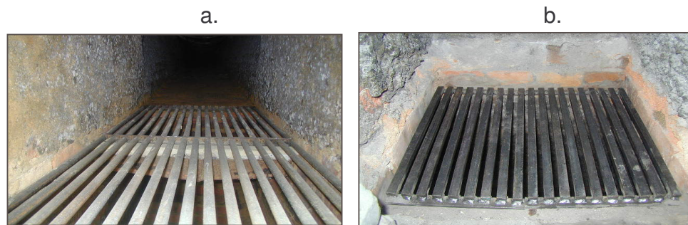
Figura 11. Parrilla de 60% área libre de la cámara Plana-CIMPA (a) y parrilla de 40% área libre de la cámara Ward-CIMPA (b).
