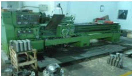
Figura 23. Torno paralelo universal TORNOW
