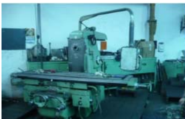
Figura 25. Fresadora universal TOS KURIM FA 5B
