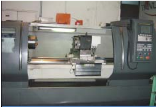
Figura 19. Torno CNC SHENYANG
