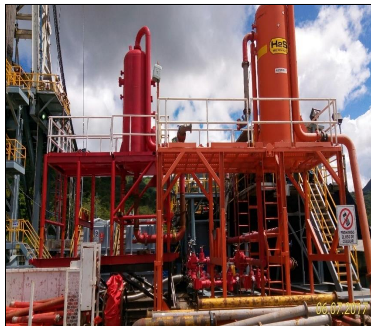
Figura 11. Separador vertical compacto utilizado en MPD y UBD.
