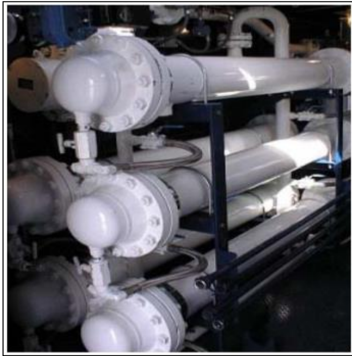
Figura 9. Sistema de filtros de membrana. Adaptado de Weatherford Underbalanced System and Testing Services (2005). Principios de perforación bajo balance y su aplicación en campos geotérmicos. Recuperado de: https://es.scribd.com/doc/233777463/Principios-de-Perforacion-Bajo-Balance
