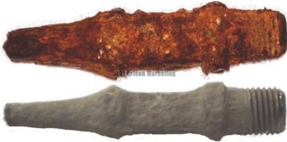
Figura 33. Varillas de Producción Corroídas por Fluidos.
