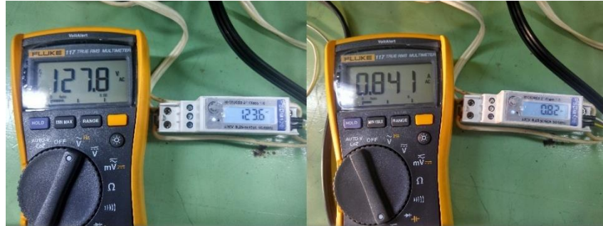
Figura 15. Medición del voltaje y la corriente de la bombilla.
