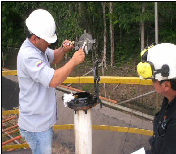
Figura 19. Medición del nivel de producto
