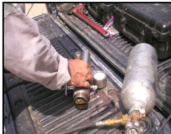
Figura 28. Carga de la pistola de gas
