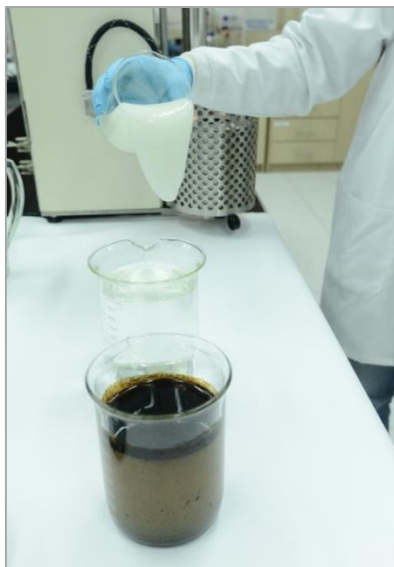
Figura 46. Fluido de fractura Guar-Boro modificado preparado con el agua de producción del campo Llanito. Fuente: El Autor.
