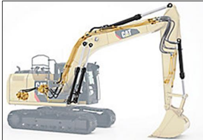
Figura 10. Sistema Hidráulico de Excavadora.
