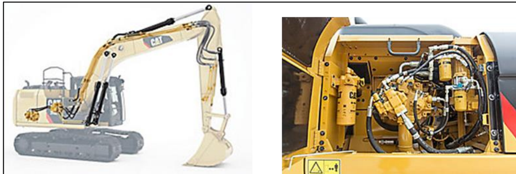
Figura 6. Sistema hidráulico de Excavadora 330CL CAT.
