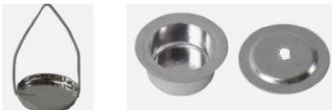
Figura 5. Imagen derecha portamuestras usados en el TGA. Imagen izquierda DSC. Imagen izquierda portamuestras usado en el DSC con una perforación en la tapa.
