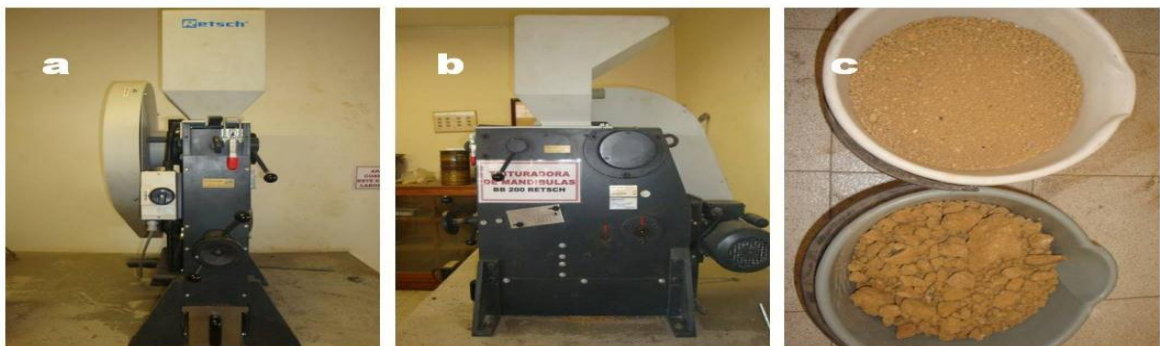
Figura 13. (a) y (b) Trituradora de Mandíbulas BB 200 RETSCH. (c) Diferencia entre la materia prima inicial y la materia prima triturada.
