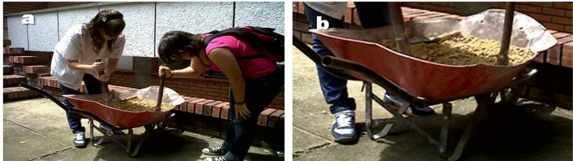
Figura 12. Fotografía de secado del material. (a) Secado natural. (b) Disgregación de materia prima compactada.
