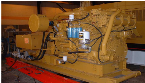
Figura 34 Motores diesel convertido a sistema dual diesel gas. 33
