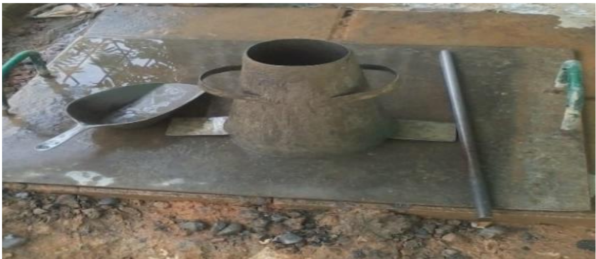
Figura 4. Cono de Abrams usado en obra.
