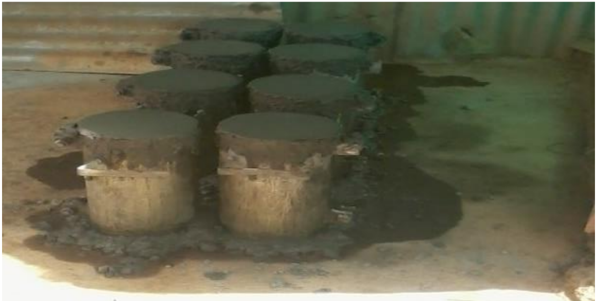
Figura 6. Encofrado de cilindros de prueba.
