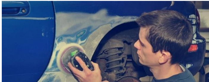
Figura 12. Polichado de pintura
