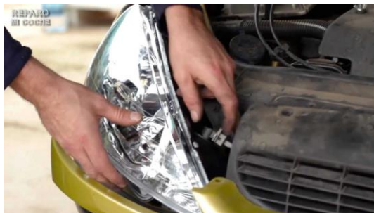
Figura 9. Cambio de faros delanteros
