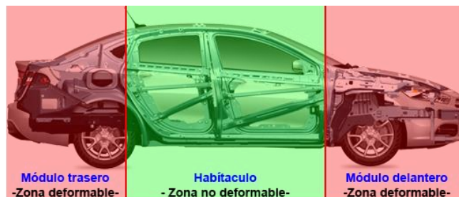
Figura 36. Deformación programada por zonas
