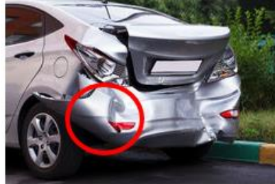
Figura 31. Pliegues en un vehículo
