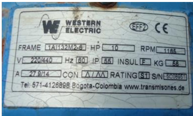
Figura 2: Placa del motor de inducción.
