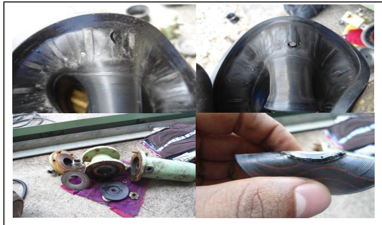
Figura 24. Imágenes de mangas y diafragmas rotos
