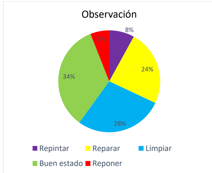
Figura 32. Estado físico de las señales verticales.
