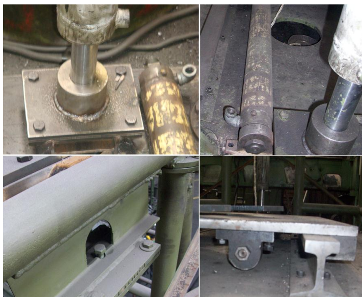
Figura 82. Fotografía del montaje de los actuadores.
