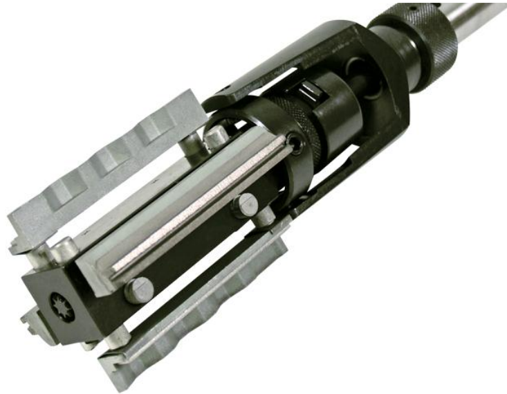
Figura 3. Herramienta para bruñir interiores de cilindros Fuente. Photographed by Britton Harper of Winona Van Norman
