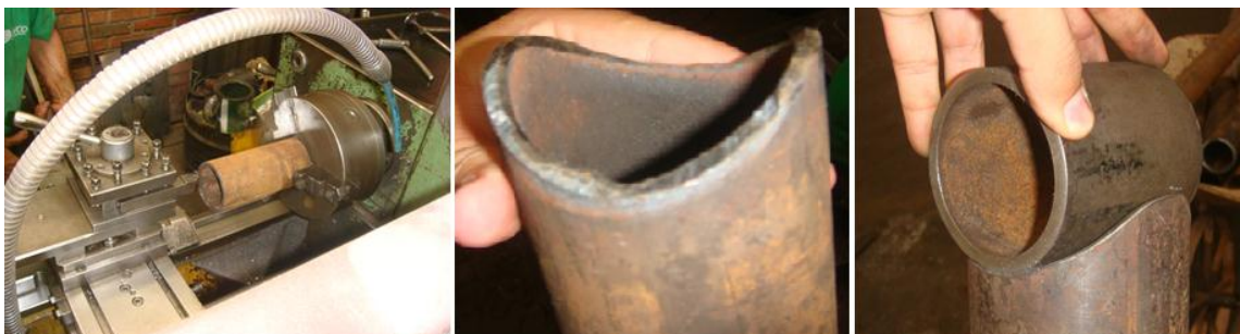
Figura 79. Fotografía de corte de tubería.
