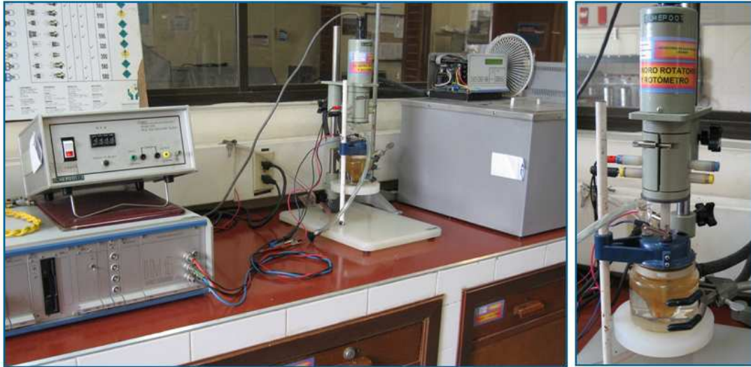
Fotografía 4 . Equipos y montaje empleado para la evaluación de la velocidad de corrosión del Acero al Carbón 1020. (Izquierda Potenciostato, ECR y Termostato. Derecha Celda de Electrodo de cilindro Rotatorio)
