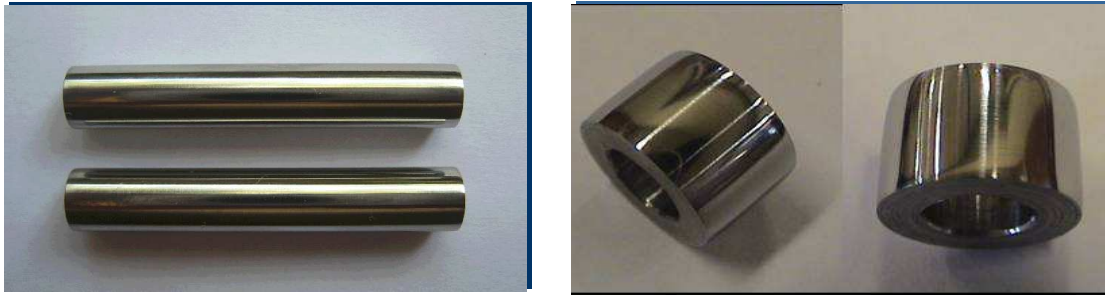
Fotografía 3. Fabricación de los electrodos para análisis de velocidad de corrosión. (Izquierda: electrodos maquinados, derecha: electrodos pulidos hasta grado 600)
