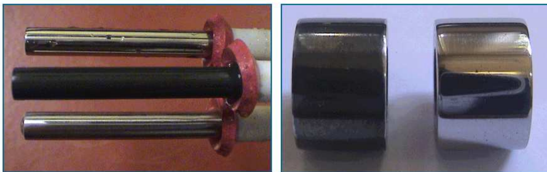
Fotografía 2. Formación de capas superficiales de productos de corrosión sobre el electrodo de acero al carbono en una solución de NaCl al 3% saturada con aire en el Autoclave y ECR.
