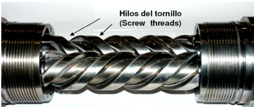
Figura 10. Etapa de una Bomba de Tornillo Gemelo.
