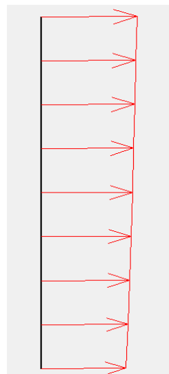
Ilustración 31: Detalle deformación Micropilotes.
