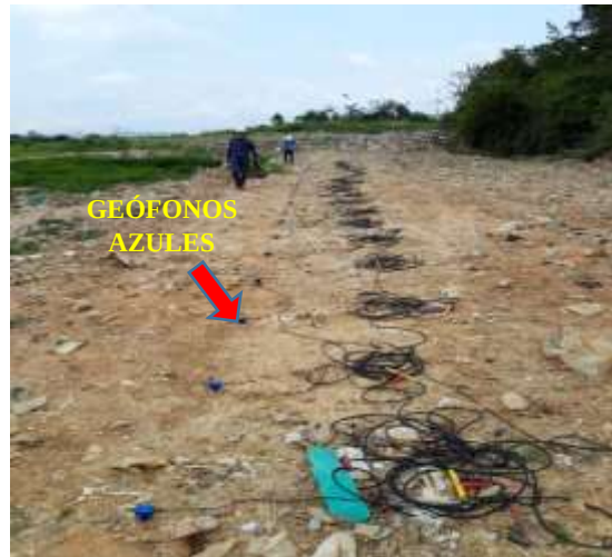
Figura 14. Geófonos azules de 14 [Hz].
