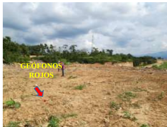
Figura 16. Geófonos rojos de 4.5 [Hz].
