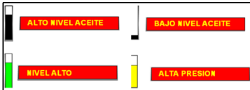
Figura 71. Condiciones anormales de operación de los FWKO's.
