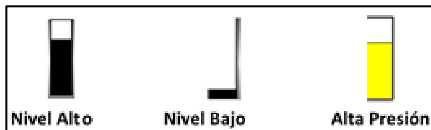
Figura 75. Condiciones anormales de los separadores
