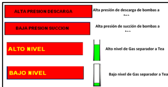
Figura 77. Alarmas y condiciones de operación del gas de separador a tea
