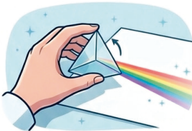
4. Gira lentamente el prisma hasta que aparezca una franja de colores.
