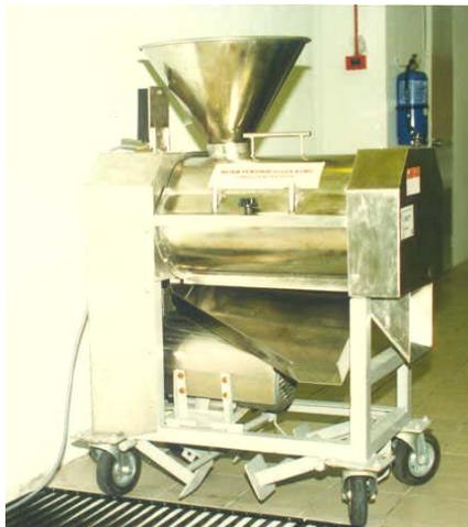
Figura 5. “Despulpadora de cacao” utilizada en el proceso de obtención de jugo de cacao en Malasia.
