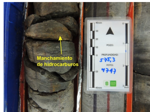
Figura 50. Manchas de hidrocarburos a 575.3 ft.
