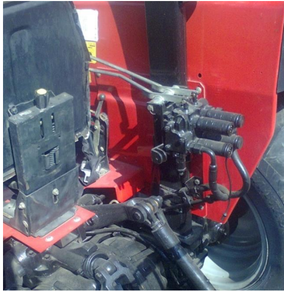
Figura 43. Mando hidráulico tres posiciones. Centro tándem
