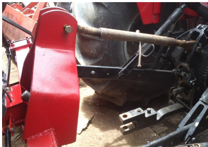
Figura 40. Enganche al tractor por medio del tercer punto
