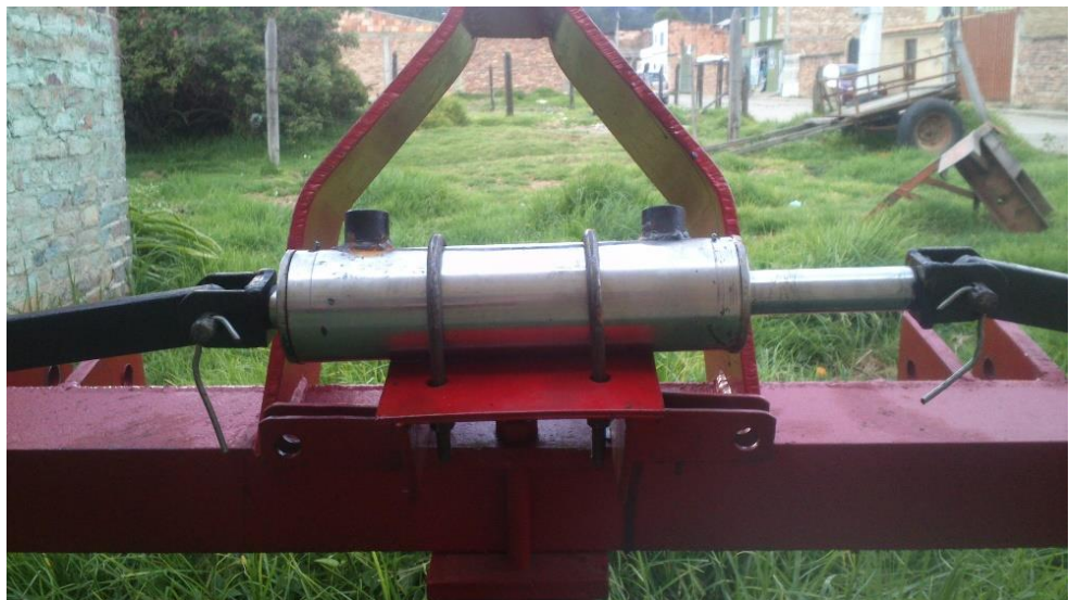
Figura 45. Posición de trabajo, barras laterales y botella hidráulica
