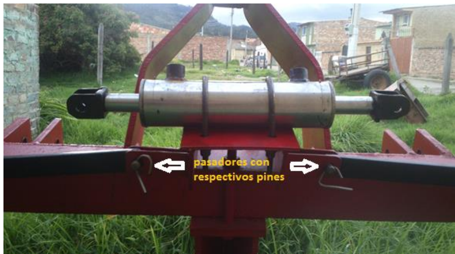
Figura 44. Posición de las barras para transportar la surcadora
