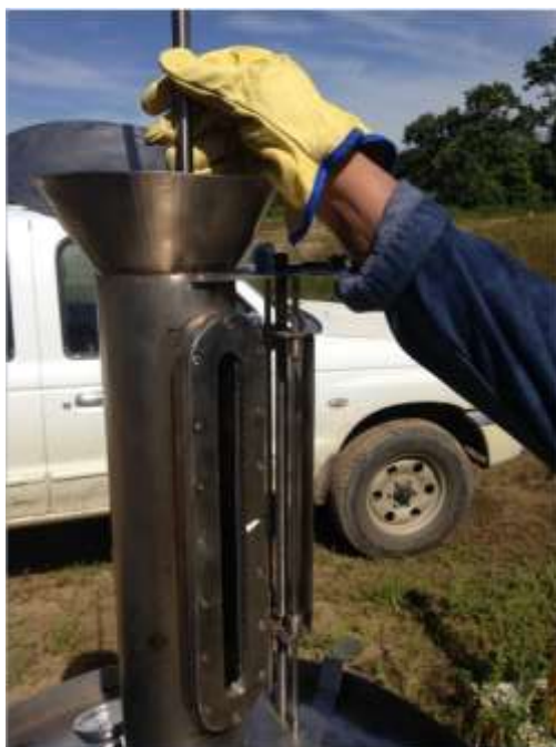
Fotografía 3. Forma de medir el volumen total e interface de aceite, utilizando una varilla impregnada con “color kut”.
