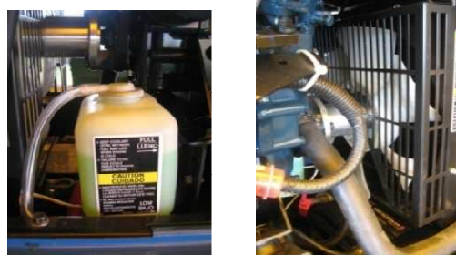
Figura 19. Líquido refrigerante, Ventilador, Radiador
