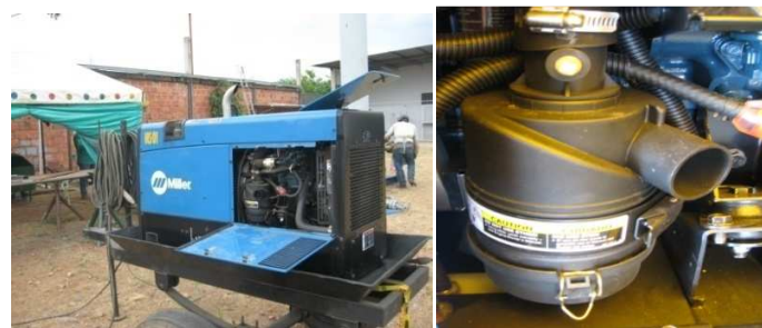
Figura 20. Filtro de aire.
