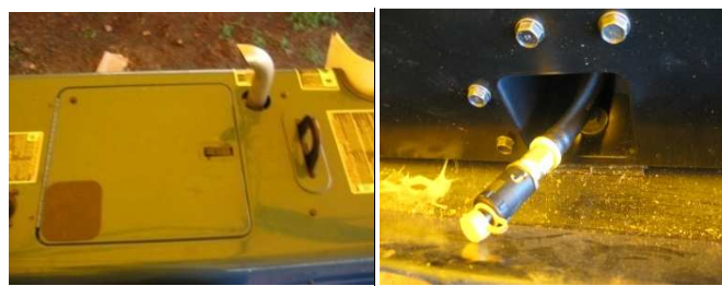
Figura 18. Tubo de escape, drenaje de aceite
