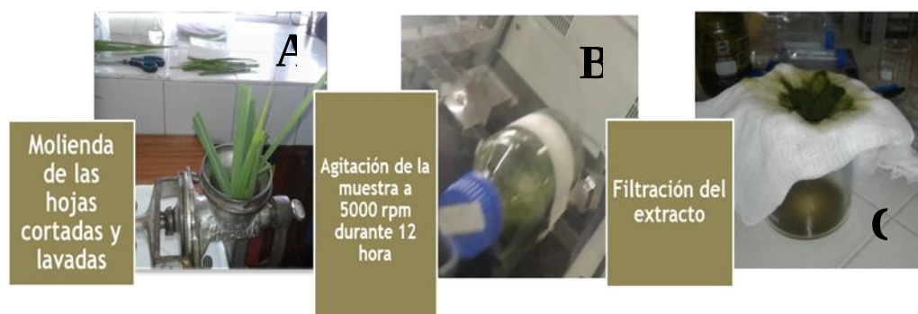
Figura 5. Primera parte del proceso extracción para la obtención del extracto crudo. A) Destrucción mecánica de la planta; B) Agitación constante buffer de extracción; C) Filtración del extracto. Fuente: Autor
