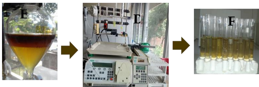
Figura 6. Segunda parte del proceso extracción para la separación en fracciones del extracto según su actividad peroxidásica. A) Eliminación de pigmentos; B) Equipo purificador de proteínas Bio-Rad Biologic; C) Fracciones recolectadas Fuente: Autor
