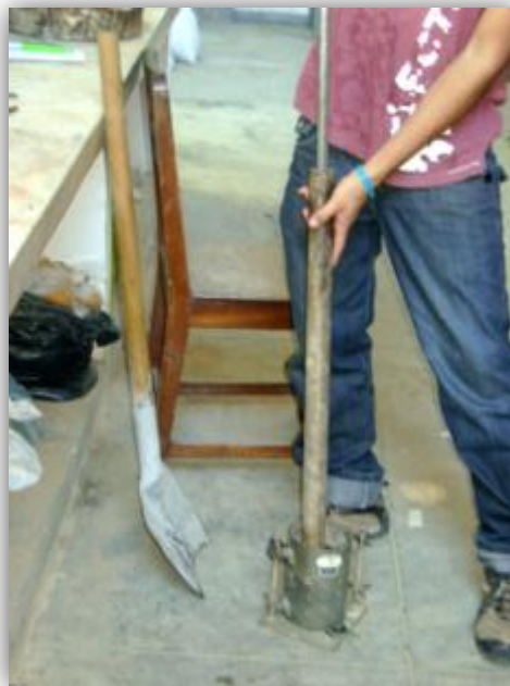
Figura 13. Procedimiento y equipos utilizados para el ensayo de compactación Fuente: Los autores
