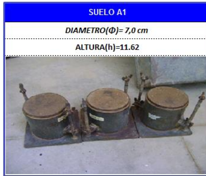
Figura 16. Especificaciones del molde de probetas
