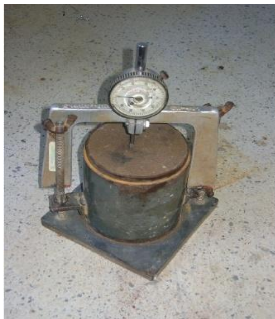
Figura 18. Montaje para la medición de Retracción de las probetas
