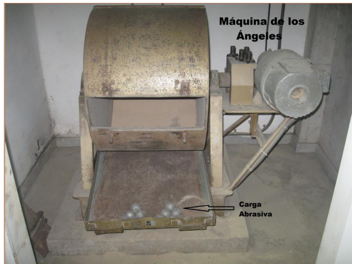
FIGURA 10. Equipos utilizados para el ensayo de resistencia al desgaste Fuente: Los autores
