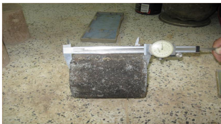
Figura 20. Características de Retracción de Fraguado mezcla 2
