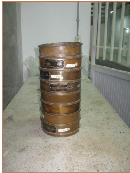
FIGURA 9. Tamices utilizados para el ensayo de granulometría Fuente: Los autores
