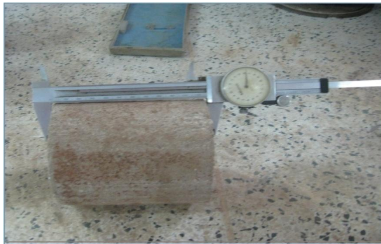
Figura 19. Características de Retracción de Fraguado mezcla 1.
