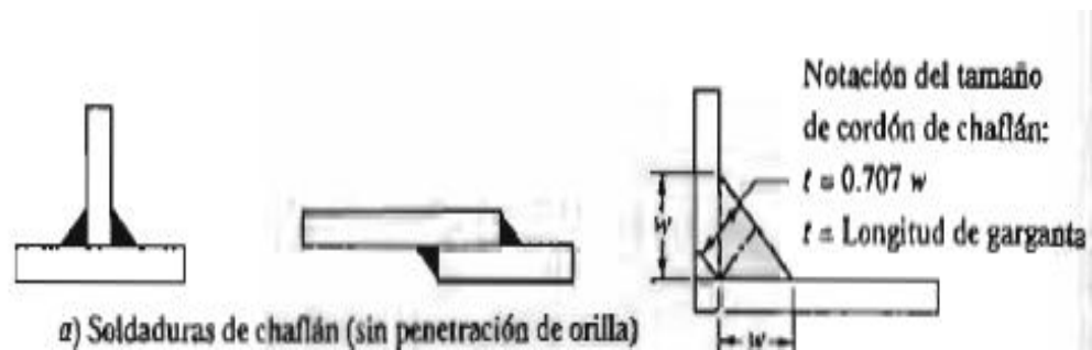
Figura 45. Ilustración de Soldadura
