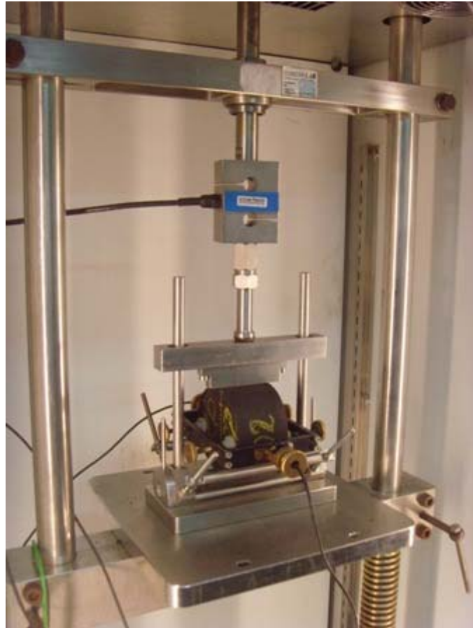
Fotografía 2. Ejecución de ensayo ITSM.
