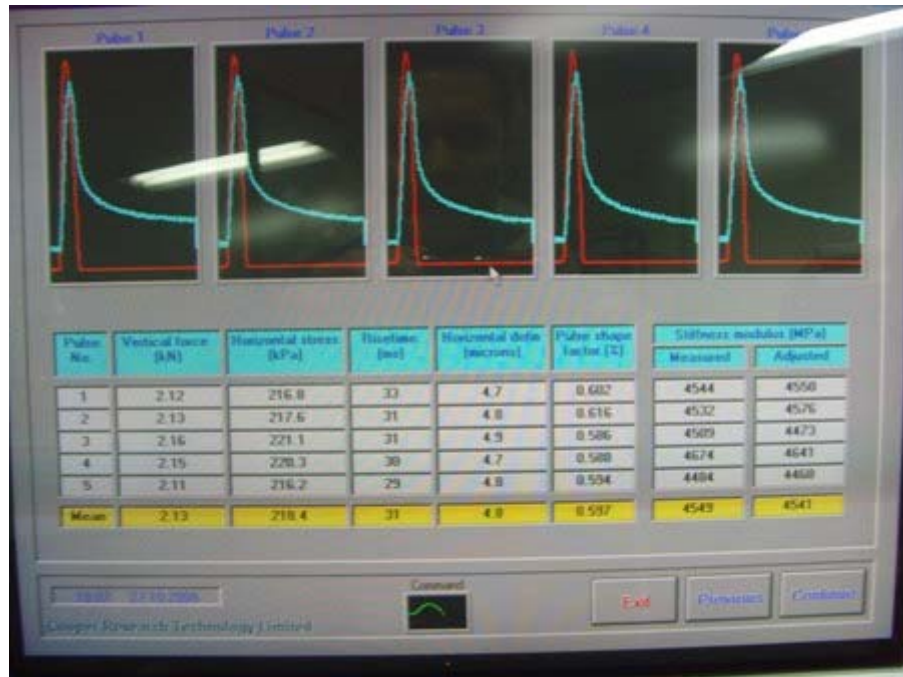
Fotografía 3. Despliegue de datos durante el ensayo ITSM.
