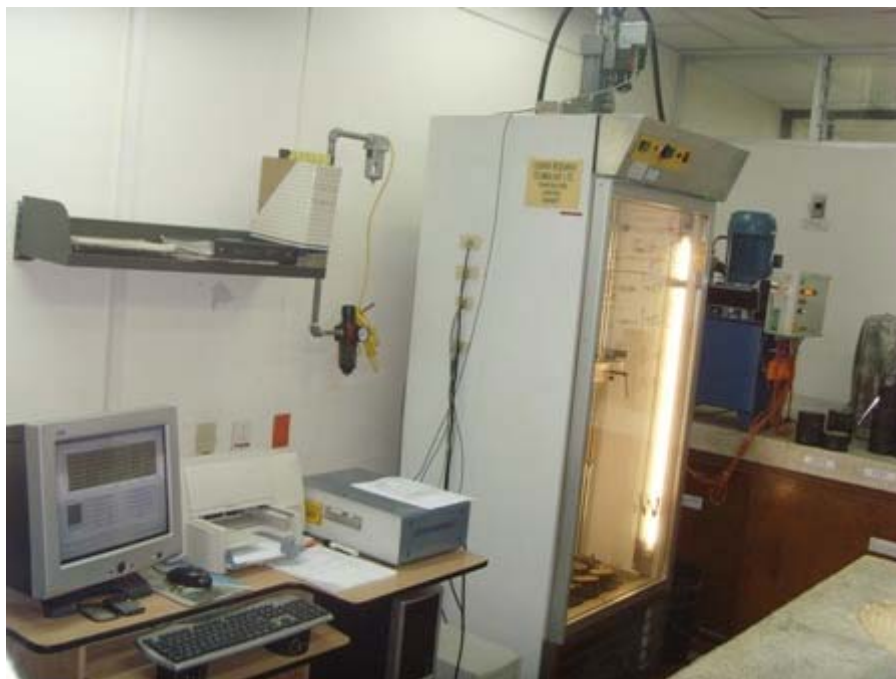
Fotografía 1. Vista general del Nottingham Asphalt Tester, NAT.
