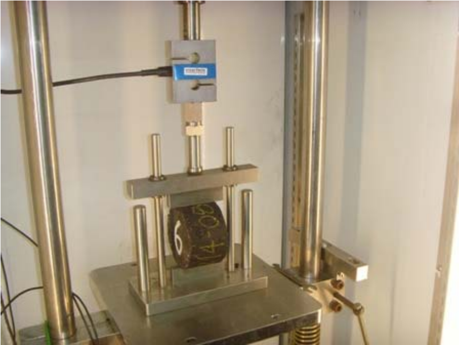
Fotografía 4. Ejecución de ensayo ITFT.
