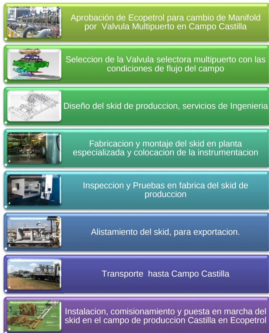
Figura 22. Diagrama de proceso de la propuesta técnica de aplicación válvula multipuerto
