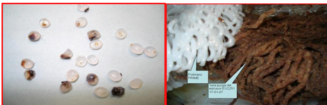
Figura 1. Polietileno degradado de la Unidad de Polietileno II (refinería de Barrancabermeja).
