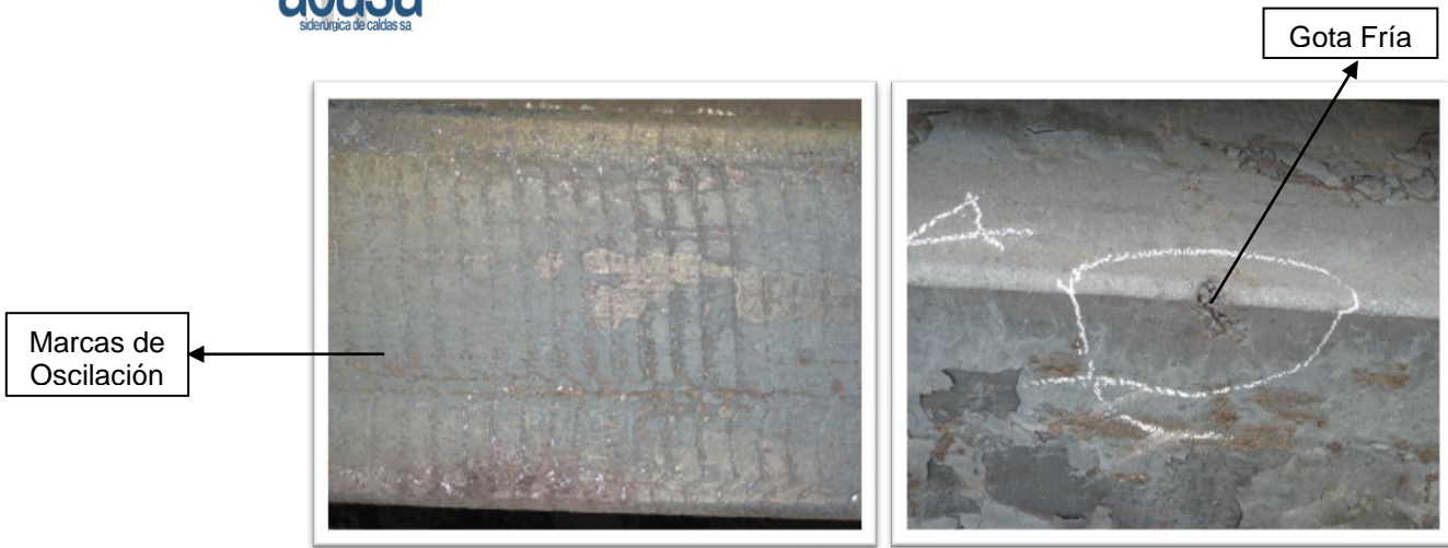
Figura 12. Defectos superficiales generados por la sobreagitación en el menisco
