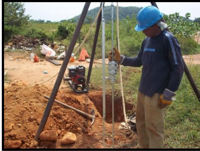
Figura 2. Ensayo Penetración Dinámica de Cono, Barrio San Fernando
