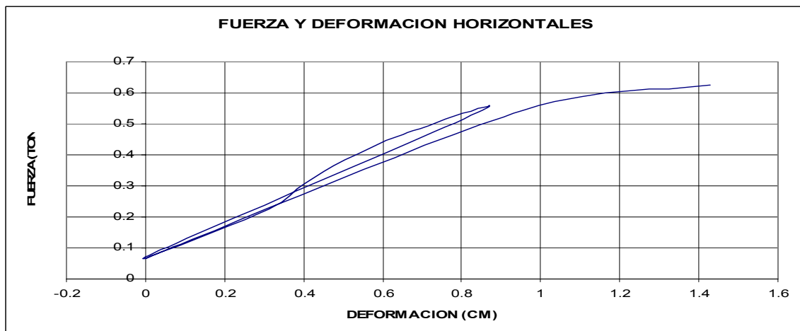
Grafica 10. Deformación vs Fuerza horizontal espécimen 3
