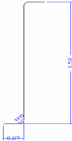
Figura 8. Refuerzo de longitudinal del espécimen
