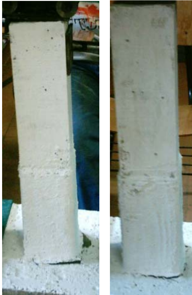
Figura 43. Falla columnas 5 y 6
