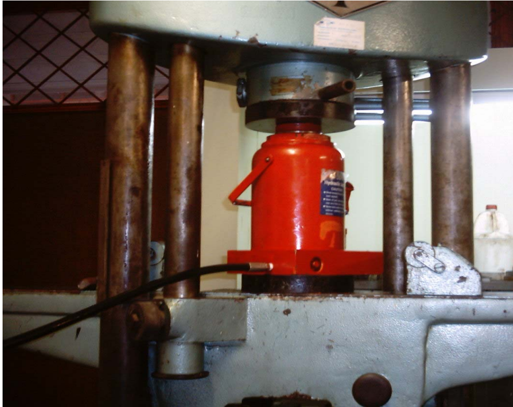
Figura 34. Calibración de los gatos en la maquina TREBEL
