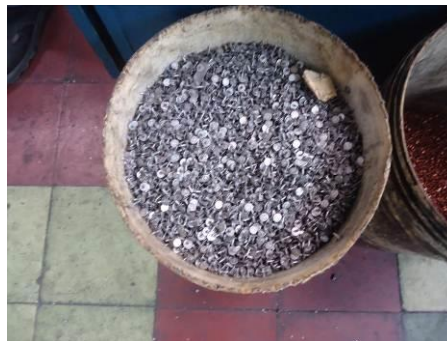
Figura 6. Cuerpos y tapas para el botón a partir de láminas de hierro calibre 0.25mm
