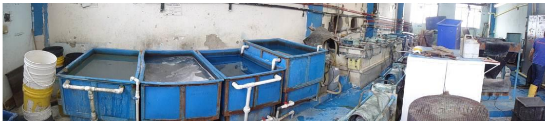
Figura 7. Secuencia de cubas para baños de chapado electrolítico
